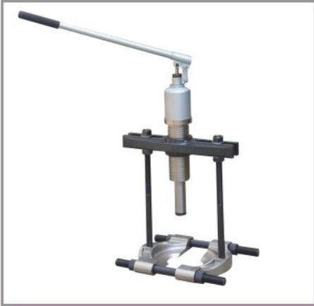
这是一套完整的拔轮器系统，它包括：液压主油缸，拔轮器，拉爪，拉杆，二片式压盘及工具箱，是拆卸压力配合零件的理想工具，如：轴瓦、轴承、轮子、齿轮及皮带轮的拆卸，特别是轴承等工作与机体的间隙极为狭小时，压盘组合可以发挥其强大的功率，缩短停机时间。
